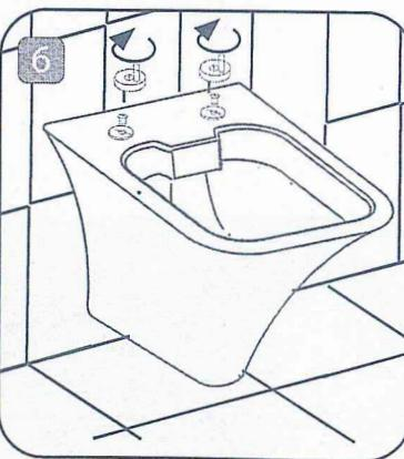
6 - Sonrasında klozet kapığı montaj aparatlarını klozeten montajını gerçekleştirdiğiniz yere takın kapak uyumunu sağlayıp montajı tamamlayın.
