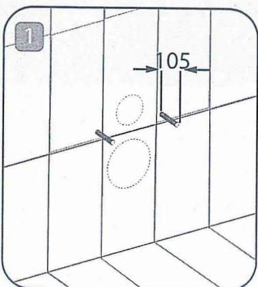
1- Gömme rezervuar içerisindeki bağlantı çubuklarını, resimde görüldüğü şekilde ve ölçüde (105mm) yerleştiriniz, gerektiği durumlarda çubukları kesibilirsiniz.
