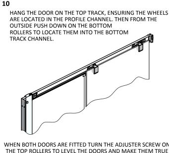
WHEN BOTH DOORS ARE FITTED TURN THE ADJUSTER SCREW ON THE TOP ROLLERS TO LEVEL THE DOORS AND MAKE THEM TRUE TO EACH OTHER.
