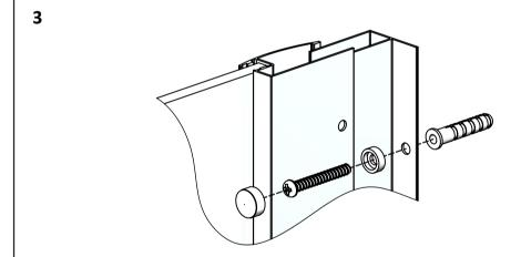
ONCE SIDE PANEL IS SQUARE AND TRUE, MARK THE POSITION OF THE SIDE PANEL'S WALL PROFILE ON THE WALL THROUGH THE WALL PROFILE FIXING HOLES USING A PENCIL.
