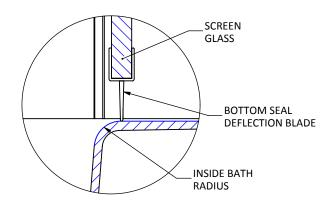
TO POSITION YOUR SCREEN, PUT THE WALL PROFILE ONTO THE END OF THE SCREEN PROFILE AND PUT THE BOTTOM SEAL ON THE BOTTOM OF THE SCREEN GLASS.
