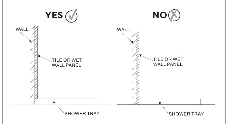
STEP 2 TRAY TO BE LEVEL MAKE SURE THE TRAY IS LEVEL, USING A SPIRIT LEVEL, BEFORE INSTALLING THIS SHOWER PANEL / DOOR, AND THAT SILICONE IS APPLIED ON ALL SIDES WHERE THE TRAY MEETS THE TILES / WET WALL PANELS.
